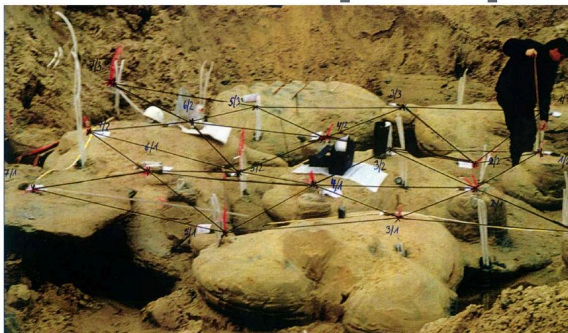
Исследование инъекционных смесей на основе особо тонкодисперсных вяжущих «Микродур» и «Интроцем» в полевых условиях
