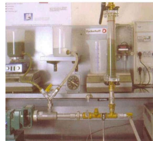
Исследования инъекционных систем на основе минеральных композиционных вяжущих на моделях грунтов
